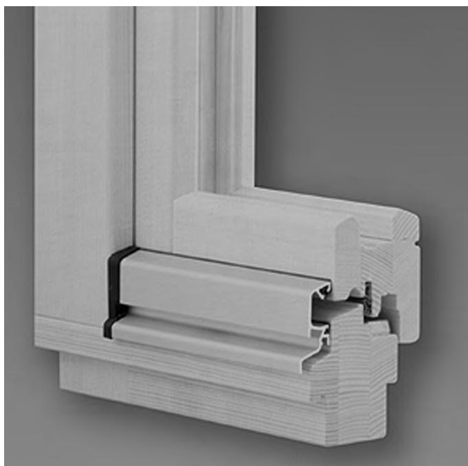
Die Abdeckprofile von BUG unterstützen die Wasserableitung aus dem Falzbereich neuzeitlicher Holzfenster und Holzfenstertüren, bieten die Möglichkeit der Festverglasung mit entsprechenden Dichtungsprofilen und verbessern das Wärmedämmverhalten des unteren Fensterrahmenholzes. Nachträglich abzudichtende Endkappen wirken gleichfalls als Kantenschutz für die Schnittkanten der Profile.
