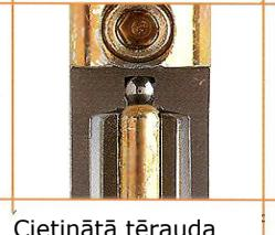
Cietināta tērauda gulta un ass sfēriskas cepurītes rotācijas procesā nerodas berze, kas nodrošina šim detaļām neierobežotu mūžu bez nolietojuma laika gaitā. Modejos ar neilona buksi vērtnes dajā ass kustība ir vēl līdzīgāka un gludāka, kas to aizsargā arī pret sānisko nolietojumu. Īpaši svarīgi tas ir durvīm ar lielu svaru.
