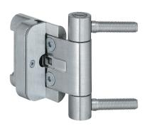
Die stufenlose 2D-Verstellung: Seite/Andruck +/- 3 mm Verstellungen mit Innensechskant-Schlüssel 4 mm Infinitely variable 2D adjustment: Side/compression +/- 3 mm Adjustments made using a 4 mm Allen key
