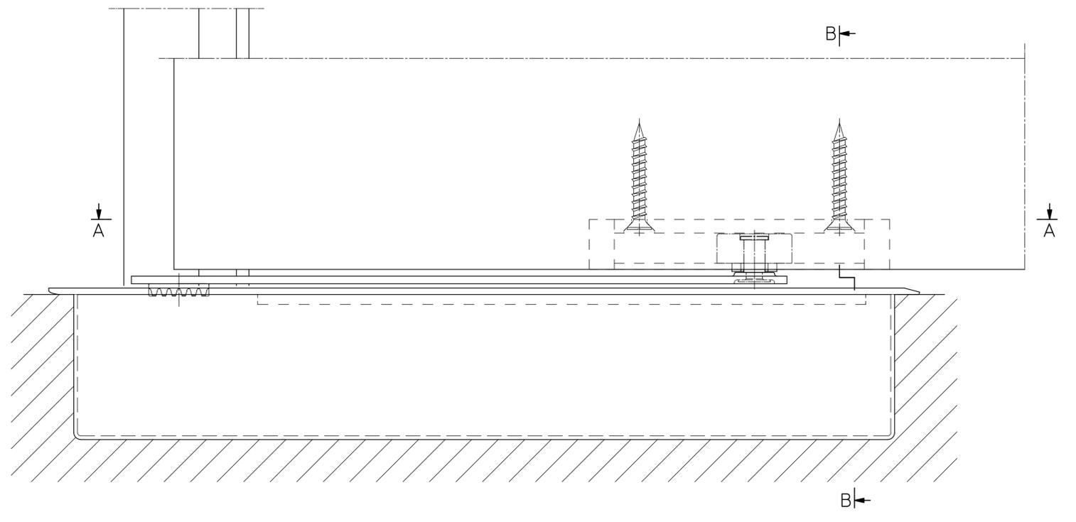
Bei Einhaltung folgender Montagemaße ist die Schließwirkung ab Türöffnungswinkel 150 Grad gegeben bei TS550NV, TS550N-EN4, TS550NV-F
