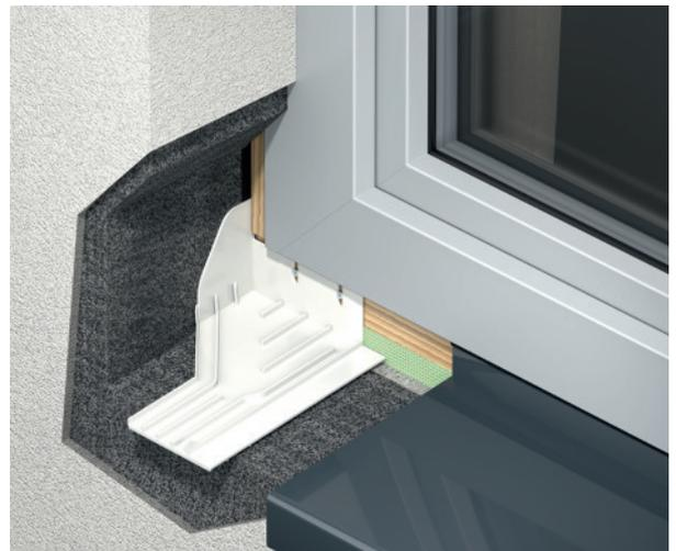
Zur Montage des Bauteiles, passend zum Fensterbanksystem GUTMANN GS 40/GS 25 ist keine Vorplanung nötig. Es wird ganz einfach außen am Blendrahmen des Fensters befestigt. Unter der Fensterbank montiert, leitet es eindringende Feuchtigkeit zuverlässig nach außen ab und verhindert damit kostspielige Bauschäden.
