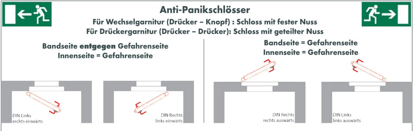
**1023, Rohrrahmenschlösser, mit Anti-Panikfunktion E, Stulp 24 x 255 mm, Klasse 3, nach DIN 18250 FS**
