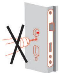
Das Türblatt darf nach dem Einbau des Schlosses nicht durchbohrt werden.
