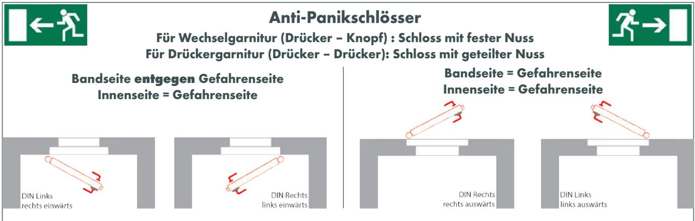
**290 P PF**, Haustürschloss, mit Anti-Panikfunktion, falz, mit 9 mm fester Nuss für Wechselgarnitur (Drücker/Knopf), mit Stahlriegel, Falle und Nuss aus Temperguss, mit Wechsel, 2-tourig
