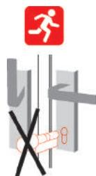
Bei Schlössern mit einer Anti-Panik Funktion dürfen keine Freilaufzylinder wie z.B. Knäufzylinder verwendet werden.
