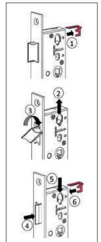
So wird die Falle umgelegt (nicht nach dem Einbau möglich!)
