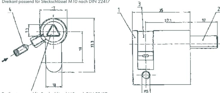
Dreikant passend für Steckschlüssel M5 nach DIN 22417
