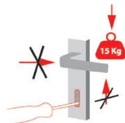
Der Drücker darf nur in Betätigungsrichtung mit maximal 150 N verwendet werden. Das Schloss darf nicht mit artfremden Gegenständen geöffnet werden.
