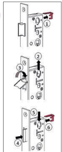
So wird die Falle umgelegt (nicht nach Einbau möglich!)
