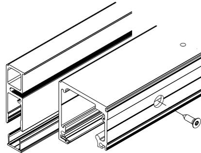
Das Profil für die Festverglasung wird mittels Spezial-Senkschrauben an die Laufschiene geschraubt und mit dem Abdeckprofil von unten verblendet.
